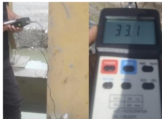
Gambar 4.1 pengukuran getaran Jaw Crusher
