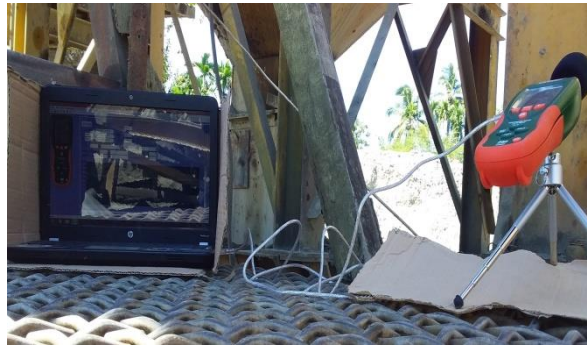
Gambar 4.4 pengukuran kebisingan Jaw Crusher
