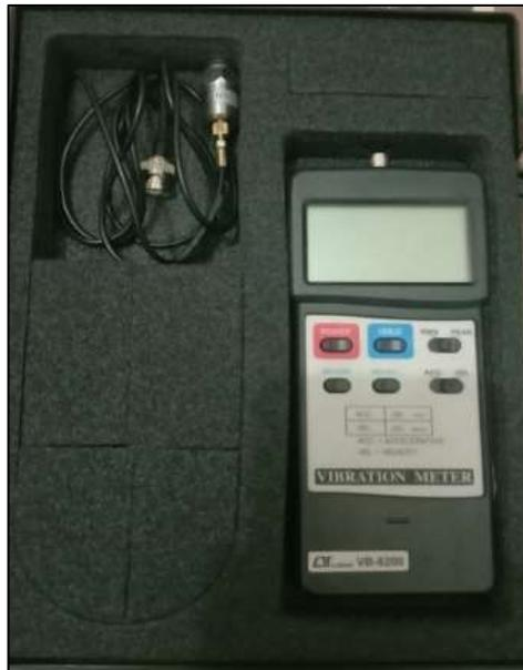
**Gambar 4.2.** Alat ukur getaran *Vibration Meter*
