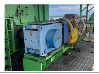
Motor penggerak pada Belt Conveyor
