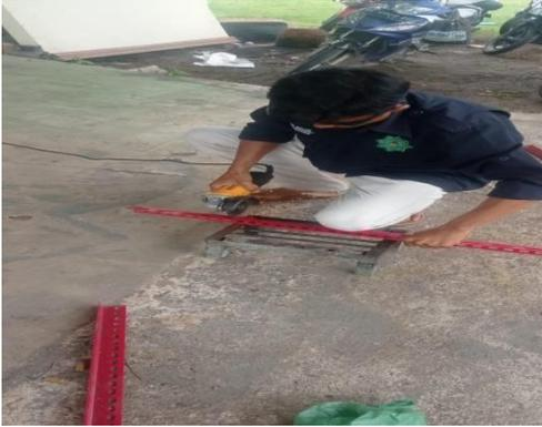
Proses pemotongan rangka
