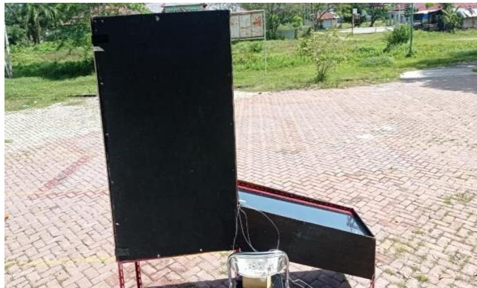
**Gambar 4.1** Alat Pengering Solar Kolektor
