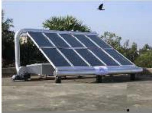
Gambar 2.4. Contoh mesin pengering tenaga surya,
