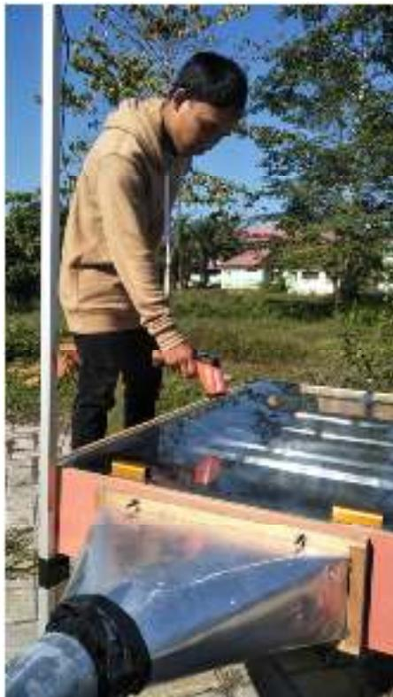
Gambar 4.5 Pengukuran temperature pada kaca
