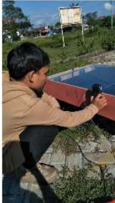
Gambar 4.3. Pengukuran Intensitas Radiasi Matahari Pada Kolektor Surya
