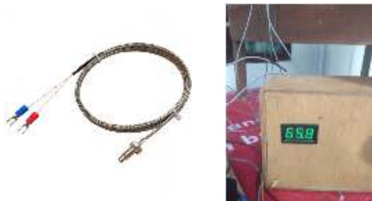
Gambar 3.9 Thermocouple dan pembaca suhu digital
