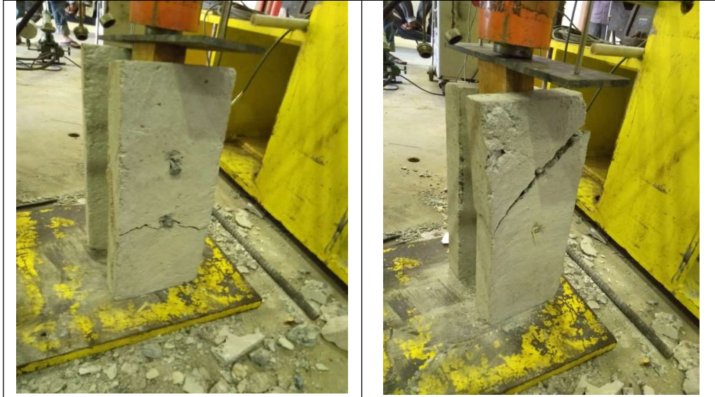
Gambar A.1.7 Kerusakan Pada Beton Pracetak
