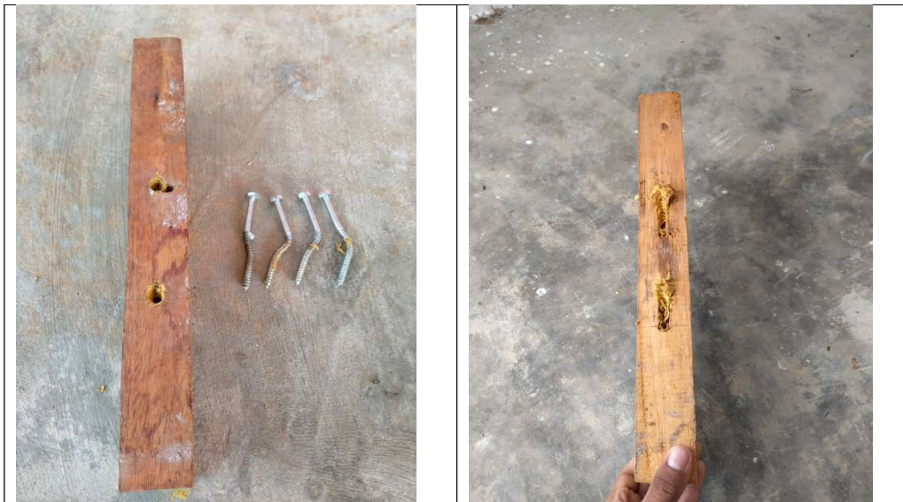
Gambar A.1.8 Kerusakan Pada Sekrup dan Kayu
