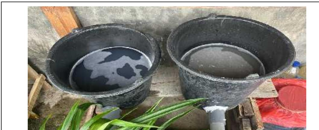
Gambar 3.4 Kondisi air limbah sebelum difitoremediasi dengan konsep CWS
