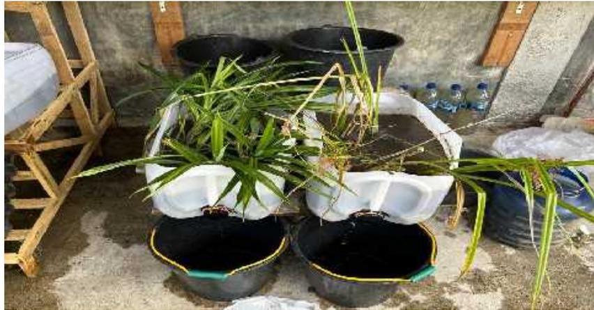
Gambar 3.9 Proses *fitoremediasi* air limbah selama waktu kontak 9 hari
