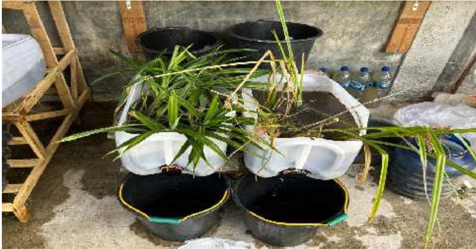
**Gambar A.9** Proses *fitoremediasi* air limbah selama waktu kontak 9 hari
