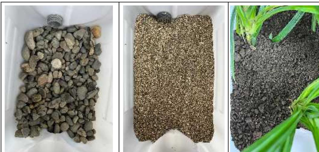
Gambar 3.6 Media filter berupa kerikil, pasir karang, dan pasir
