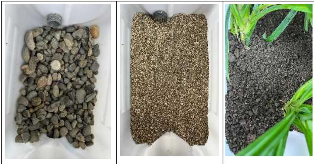
**Gambar A.7 Media filter berupa kerikil, pasir karang, dan pasir**
