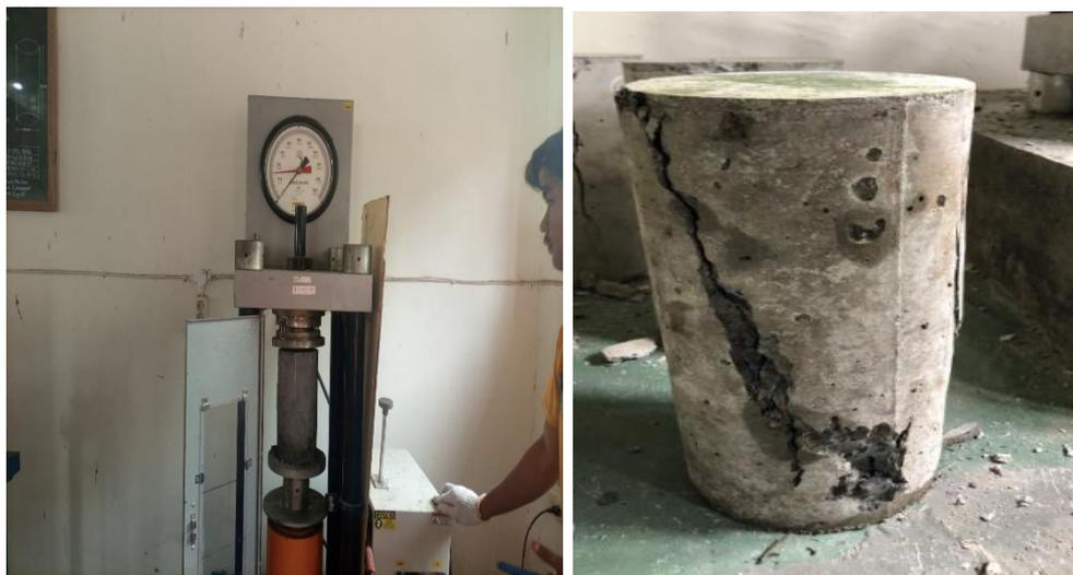
Gambar Pengujian Kuat Tekan Beton
