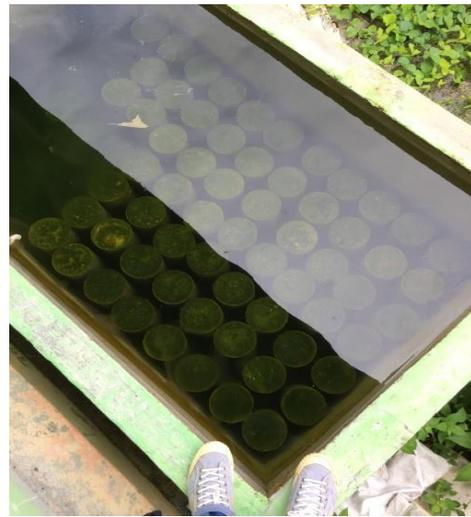
Gambar Proses Perawatan Benda Uji Beton
