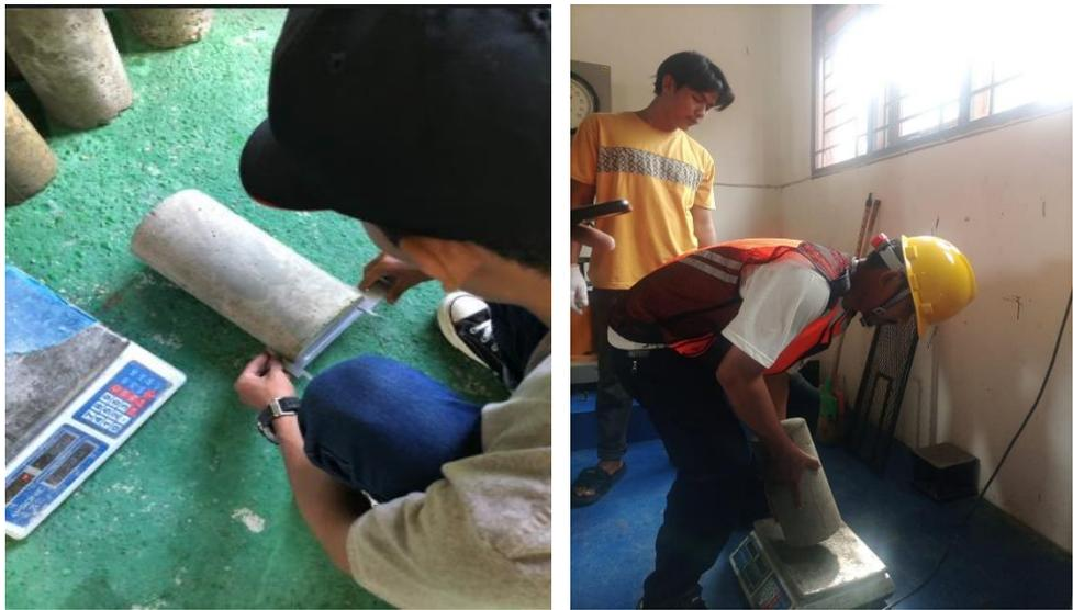
Gambar Pengukuran dan Penimbangan Benda Uji Beton
