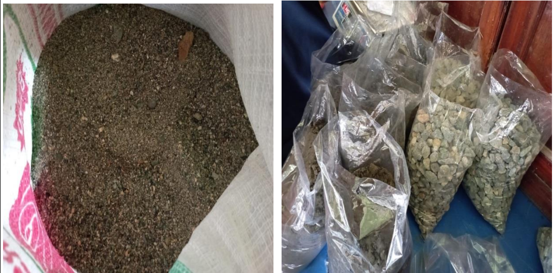
Gambar pasir sebagai agregat halus dan batu pecah sebagai agregat kasar.
