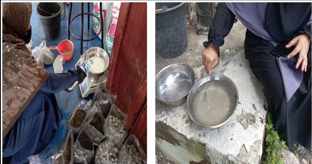
Gambar proses pembuatan larutan NaOH dan pencampuran \text{Na}_2\text{SiO}_3 dengan larutan NaOH.
