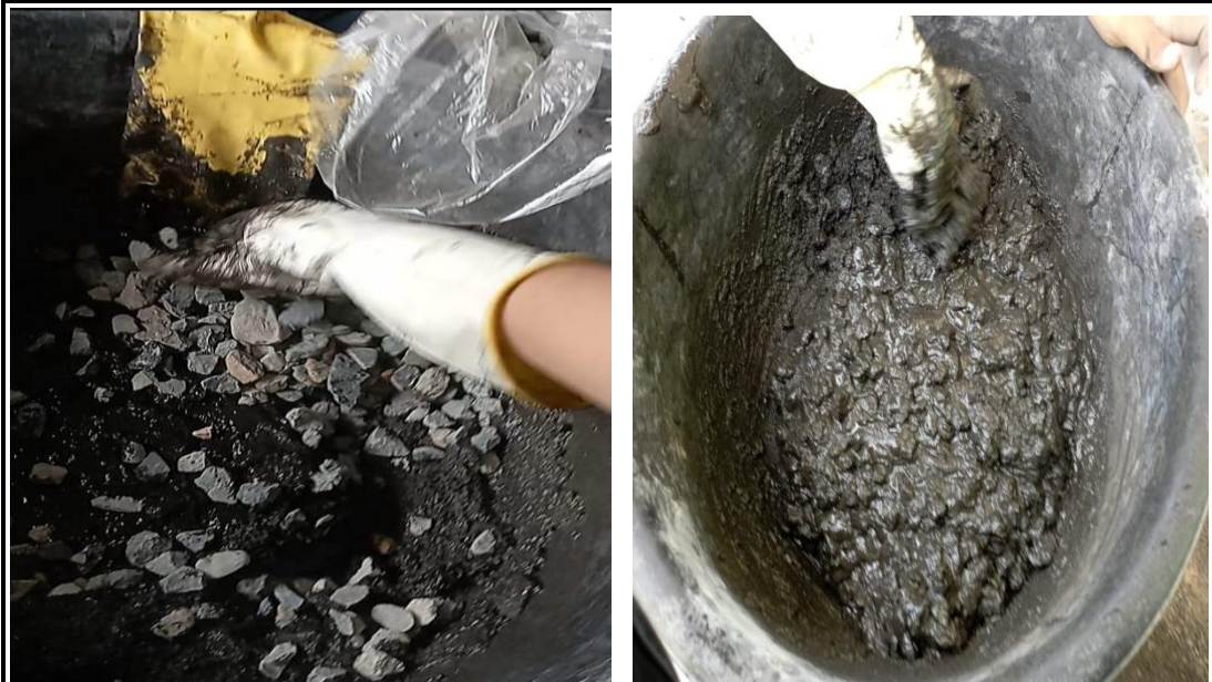
Gambar proses pencampuran agregat kedalam adonan fly ash .
