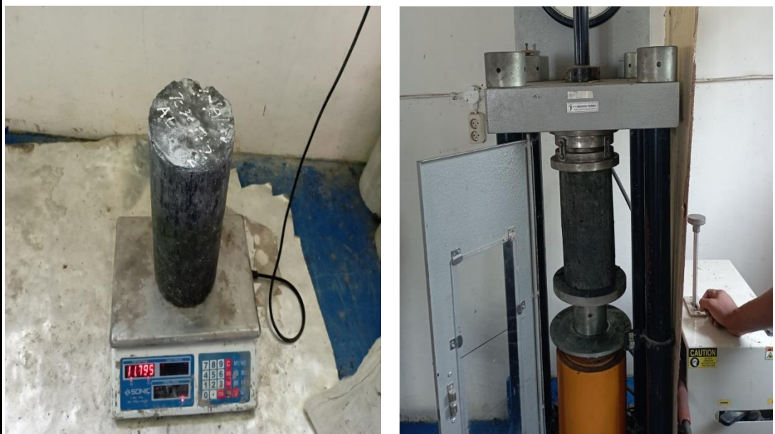
Gambar pengujian kuat tekan beton geopolymer
