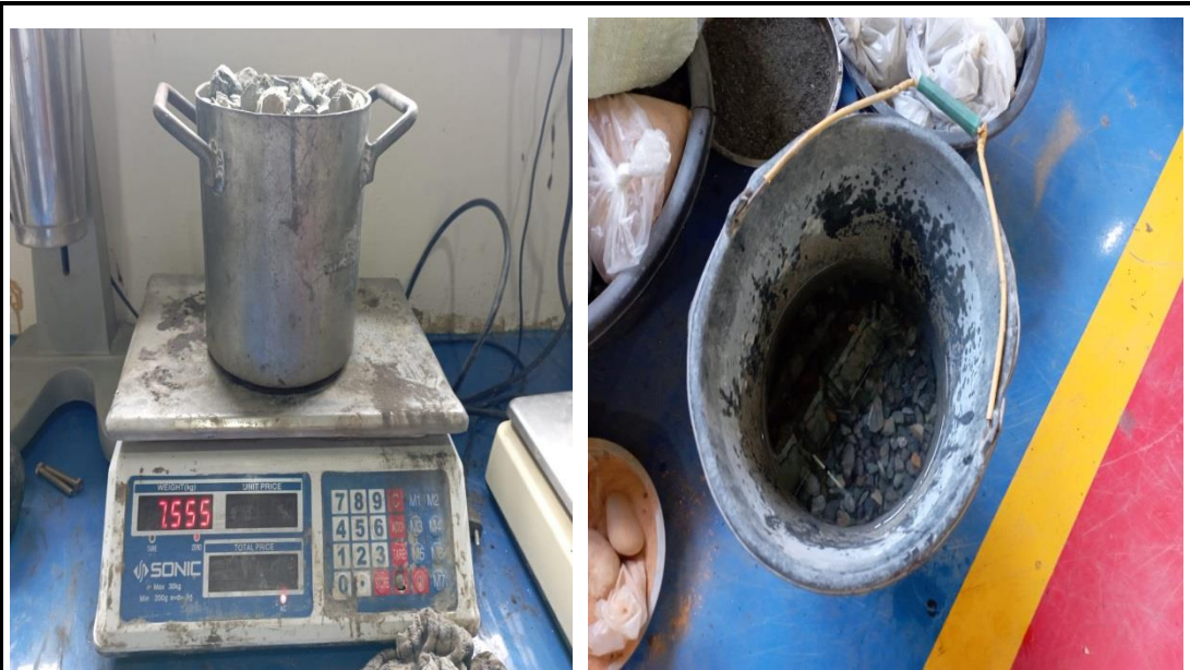
Gambar penimbangan pemeriksaan berat isi agregat dan perendaman agregat untuk pemeriksaan berat jenis.
