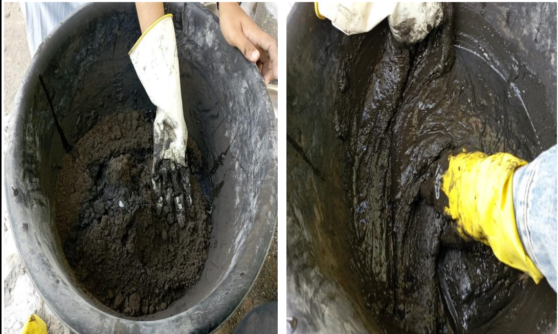
Gambar proses pencampuran fly ash dan alkalin.
