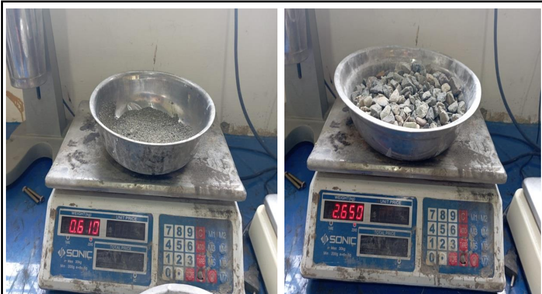
Gambar penimbangan agregat untuk pemeriksaan kadar air agregat.
