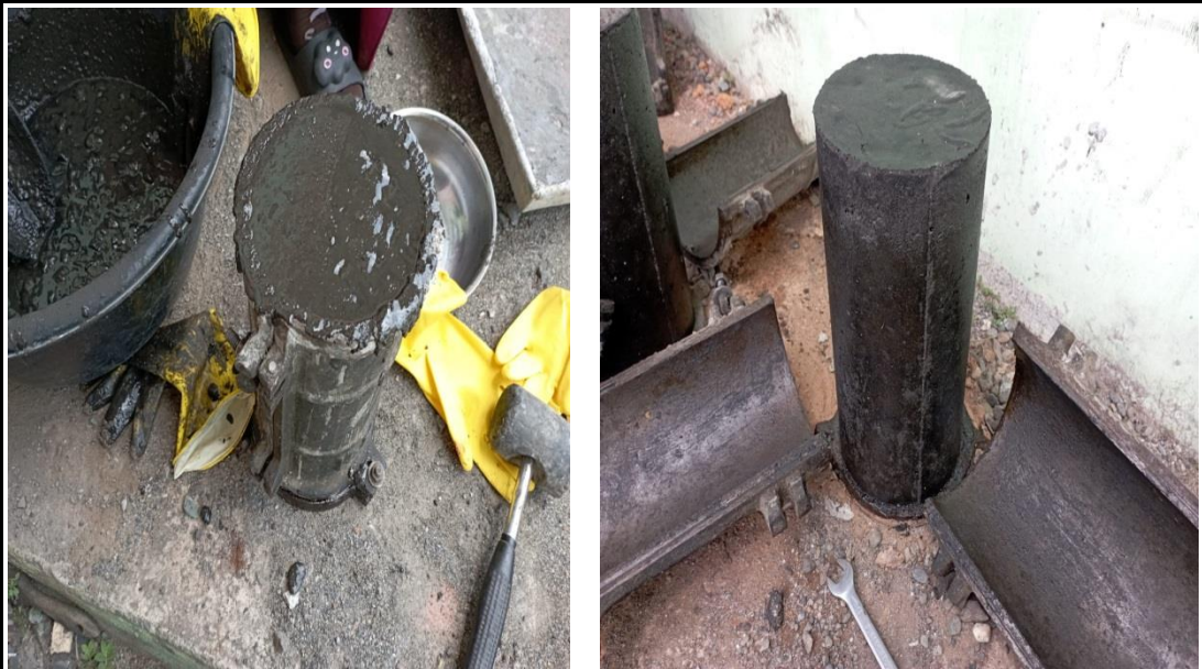
Gambar proses pengeringan beton geopolymer dan pembukaan cetakan, yang selanjutnya beton akan direndam selama 28 hari.
