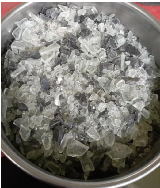
Gambar kaca sebagai bahan additive agregat halus dan waterglass ( \text{Na}_2\text{SiO}_3 ).
