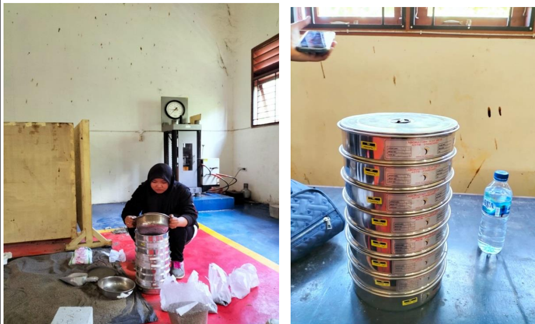
Gambar pemeriksaan analisis saringan agregat.
