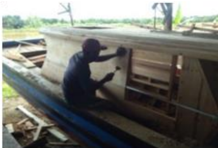
Pemasangan rumah kapal
