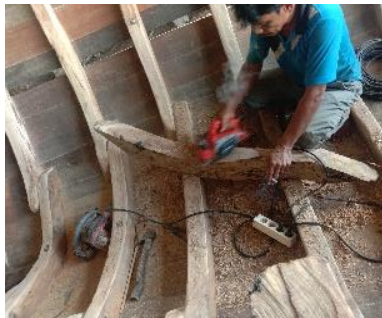
Pemasangan gading-gading tajuk (lanjut)
