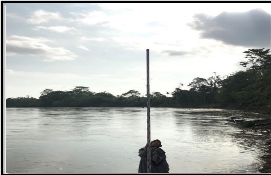
Gambar A.4.2 : Pengukuran Kedalaman Sungai
