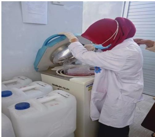
Gambar 9 : Proses Sterilisasi Basah Semua Alat Yang Sudah Di Gunakan Dimasukan Kedalam Autoclaf
