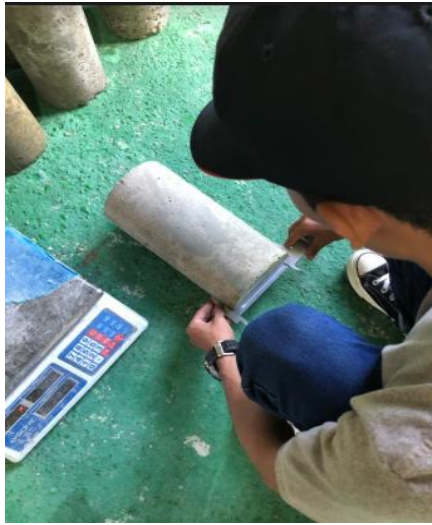
Gambar Benda Uji Setelah Proses Pengecoran Sumber : Lapangan
