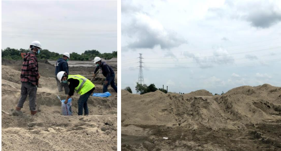
Gambar Proses Pengambilan Fly Ash batubara Sumber : Lapangan
