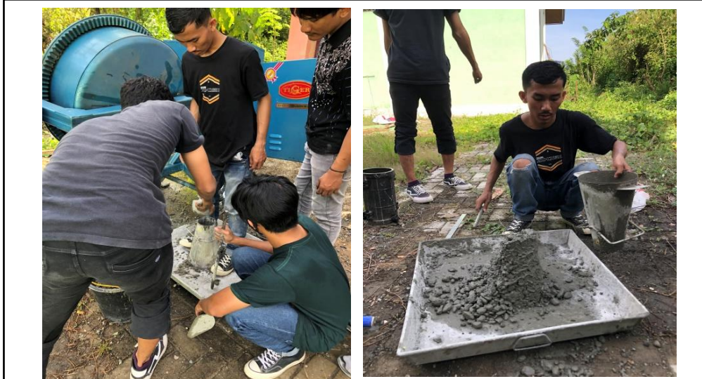
Gambar Proses Pengujian Slump Test Beton Segar Sumber : Lapangan
