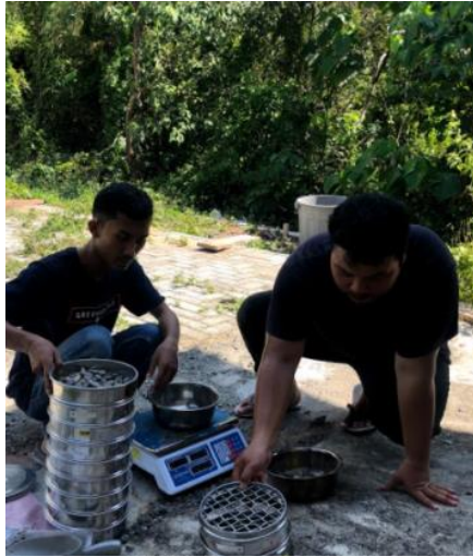
Gambar Pemeriksaan Sifat Fisis Agregat Sumber : Lapangan
