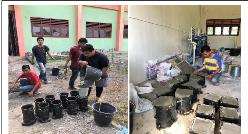
Gambar Proses Penuangan Campuran Beton kedalam Cetakan Silinder Sumber : Lapangan
