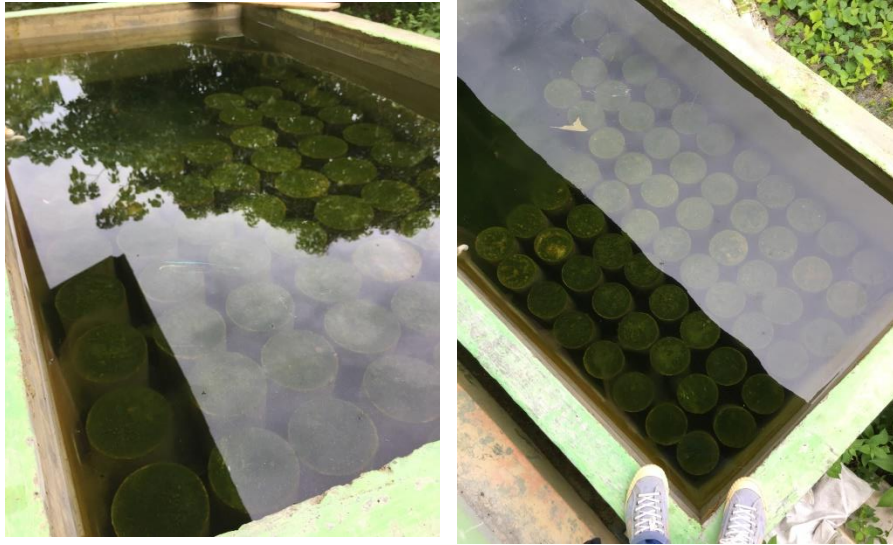
Gambar Proses Perawatan Benda Uji Beton Sumber : Lapangan
