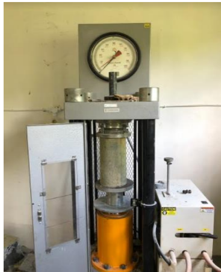
Gambar Pengujian Kuat Tekan Beton Sumber : Lapangan
