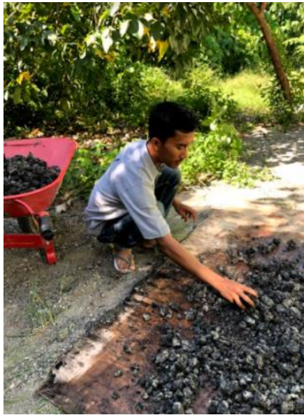
Gambar Proses Saringan Fly Ash Batubara Sumber : Lapangan
