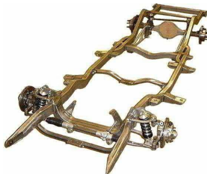
Gambar 2.4 Ladder Frame (Sumber: Nur Arifin. 2019)
