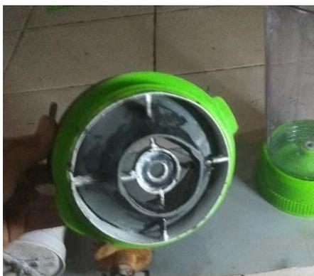
Gambar 4.16 Rangka Dudukan Bantalan Atas Yang Sudah Terpasang
