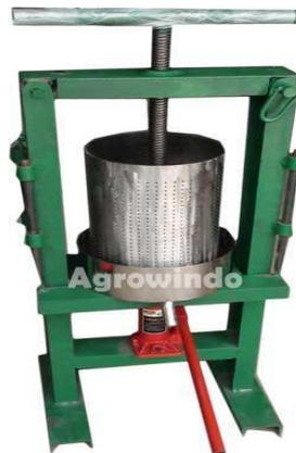
Gambar 2.5 Mesin Pemas Santan Sistem Hidrolik
