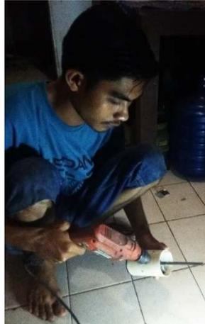
Gambar 4.14 Proses Pelubangan Sisi Tabung
