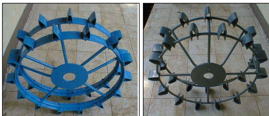
Gambar 2.13 Roda besi prototip ideal (kiri) dan prototip industri (kanan) (Sumber : Radite P.A.S, Wawan Hermawan, Adhi Soembagijo. 2008)
