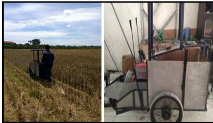
Gambar 2.5 Gerak Jalan Mesin Menggunakan Sistem Dorong (Sumber : Penelitian Herdi Susanto, Zakir Husin dan Joli Supardi, 2019)
