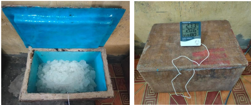
Gambar 15. Proses pengukuran temperatur coolbox (Sumber : Dokumentasi pribadi)
