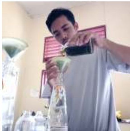
11. Penyaringan filtrat (metanol dan etil asetat)
