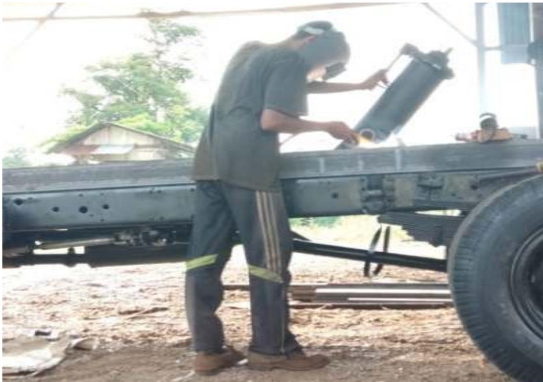
Stasiun Kerja 6. Proses pemasangan *hidrolick dump truck*
