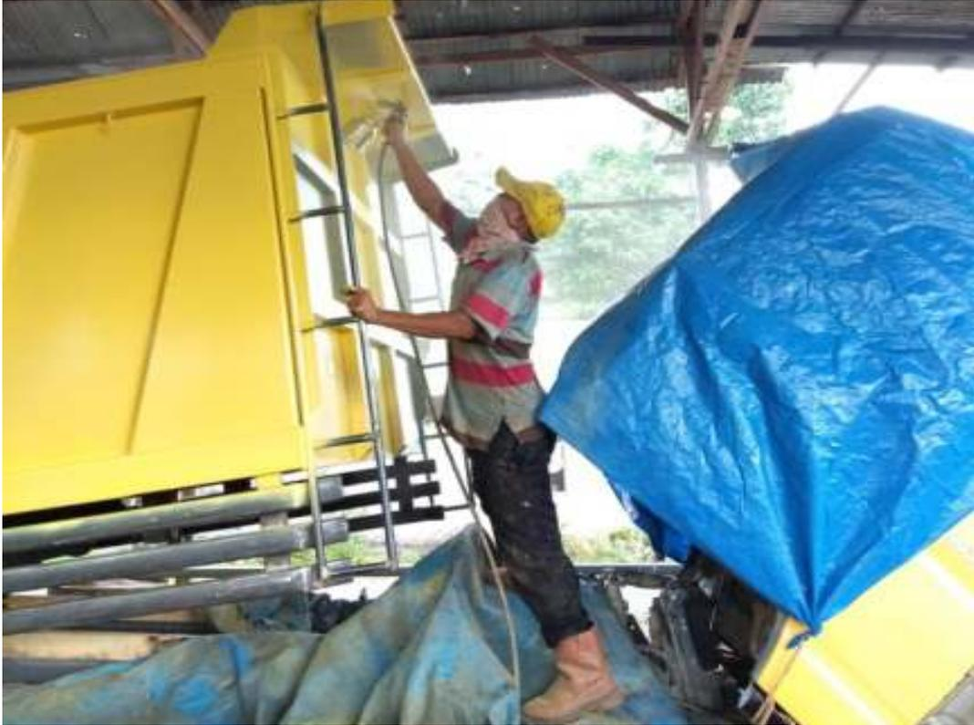
Stasiun Kerja 7. Proses pengecatan atau *finising*
