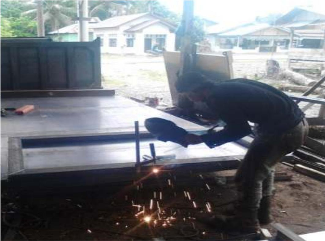
Stasiun Kerja 3. Proses pengelasan pembuatan alas *dump truck*
