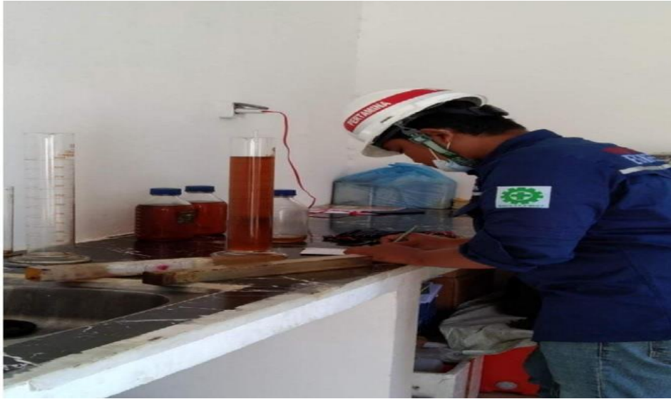
Gambar 3.2 Pengecekan Sampel Produk Menggunakan Hydrometer
