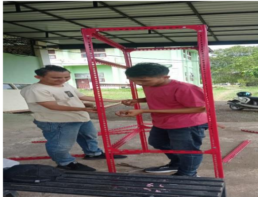
Gambar 2. Proses perakitan kerangka alat pengering
