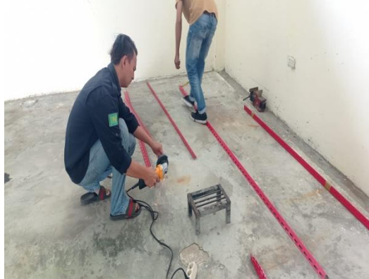
Gambar 1. Proses pemotongan besi Siku Untuk alat pengering
