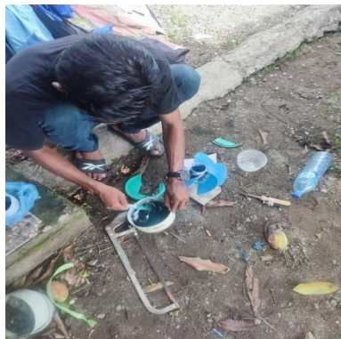
Gambar 2 (Pencampuran resin dengan katalis)
