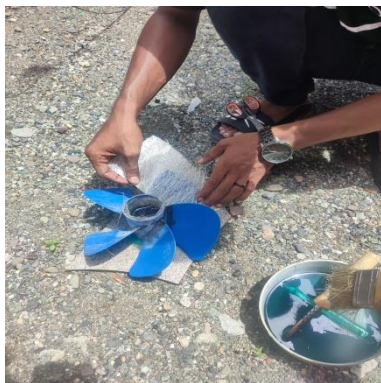
Gambar 3 (Pengolesan resin dan pelapisan serat)
