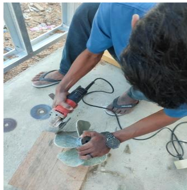
Gambar 4.4 Pelapisan Sudu Dengan Serat (Sumber : Penelitian 2022)
