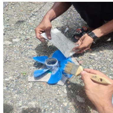
Gambar 3 (Pengolesan resin dan pelapisan serat)
