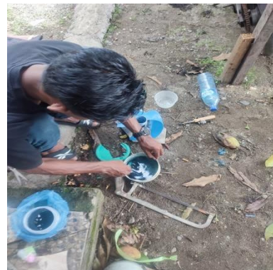
Gambar 2 (Pencampuran resin dengan katalis)
