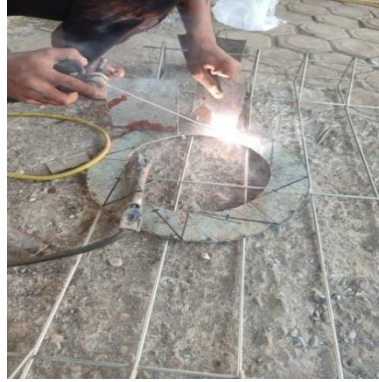
Gambar 4.6 Pembuatan sudu pengarah (Sumber : Penelitian 2022)
