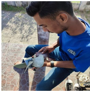
Gambar 5 (Proses pembersihan sudu)
