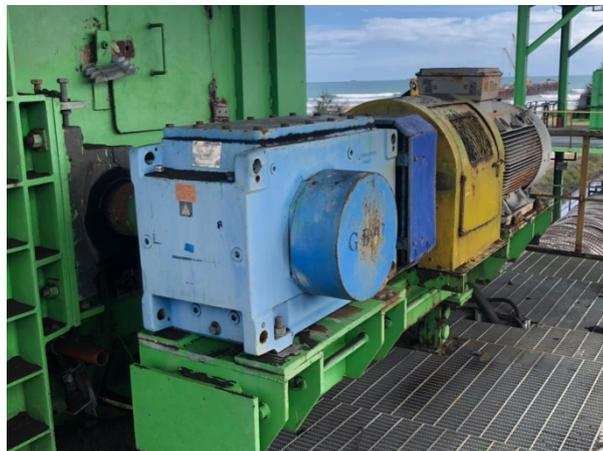
Motor penggerak pada *Belt Conveyor*
