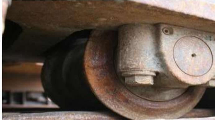
Gambar 2.1 Pemeriksaan *Track Roller* Pada *Excavator XGMAXG822EL*
