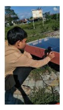
Gambar 4.3. Pengukuran Intensitas Radiasi Matahari Pada Kolektor Surya (Sumber: Penelitian)
