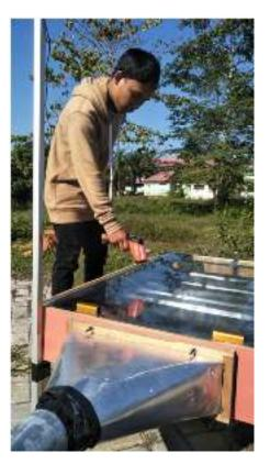
Gambar 4.5 Pengukuran temperature pada kaca (Sumber penelitian)
