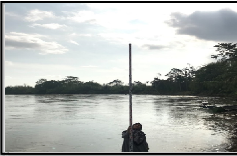
Gambar A.4.2 : Pengukuran Kedalaman Sungai
