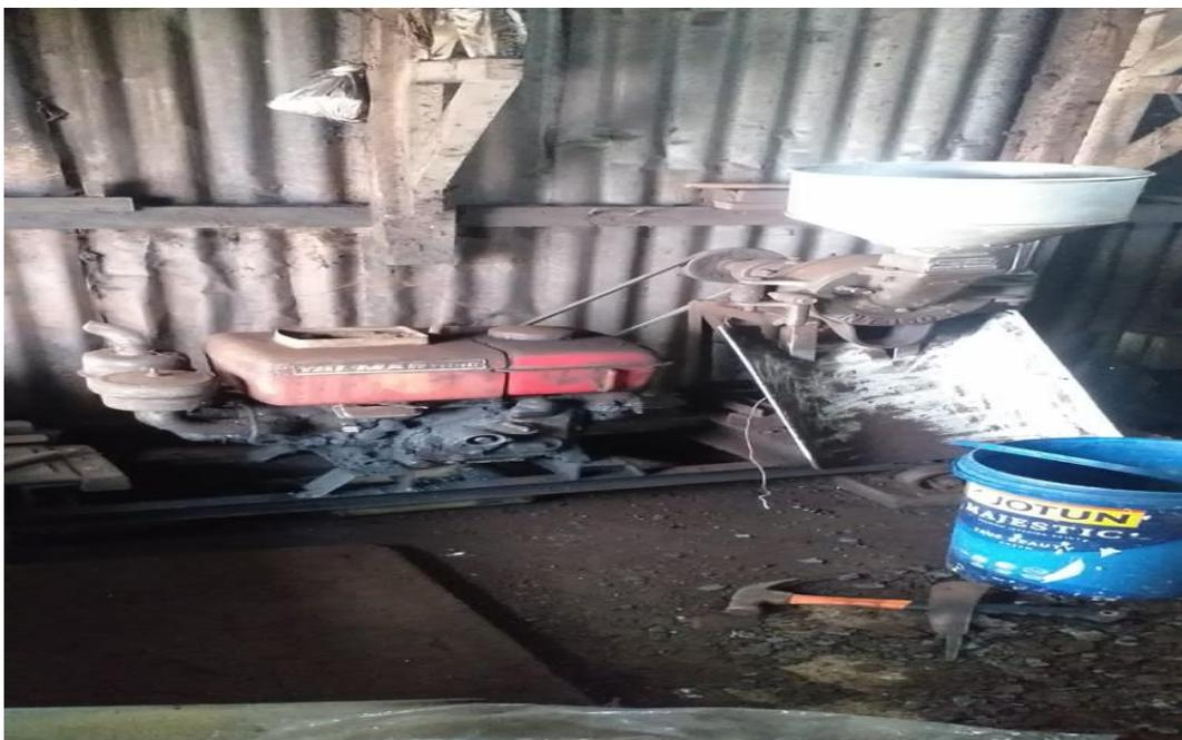
Gambar 7: Mesin Penggiling Kopi
