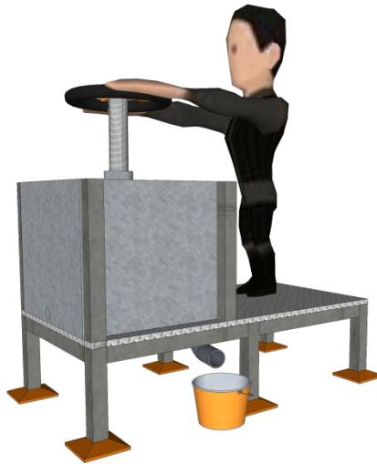
Gambar 5.5 Gambar Rancangan Alat Bantu Pengepresan Patarana Tampak Samping Kiri
