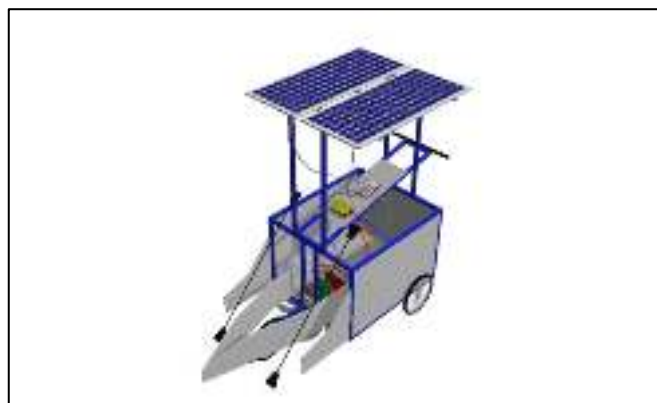
Gambar: 3.9 Desain alat setelah didesain ulang (Sumber: penelitian)
