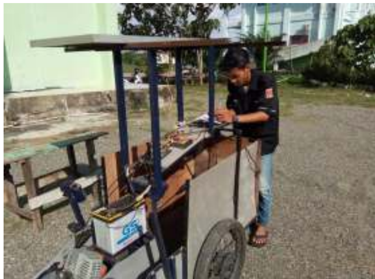
Gambar 4.2. Pengukuran kuat arus dan tegangan menggunakan satu panel surya (Sumber: Penelitian, 2019)
