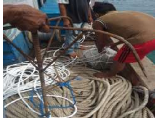
Proses mengikat jangkar pada rumpon
