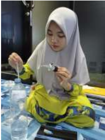
Teteskan 1 ml aquades pada prisma refraktometer
