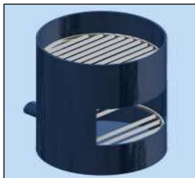
Gambar: 3.6 Hasil perancangan ruang bakar kompor briket
