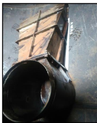
Gambar 3.8 Bucket Pabrikasi Yang belum di Modifikasi (Sumber : PLTU Unit Pembangunan Nagan Raya)
