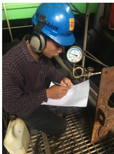
Gambar 4.1 Pengukuran Tekanan Fluida ( Sumber : penelitian. 2021 )
