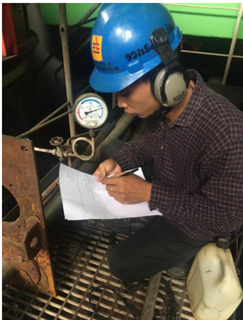
Pengujian Tekanan Fluida
