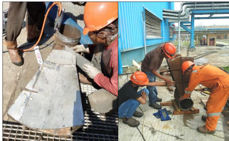
Gambar 3.11 Pembuatan Bucket ( Sumber : Penelitian.2021 )
