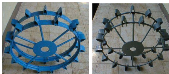
Gambar 2.12 Roda besi prototip ideal (kiri) dan prototip industri (kanan) (Sumber : Radite P.A.S, Wawan Hermawan, Adhi Soembagijo. 2008)
