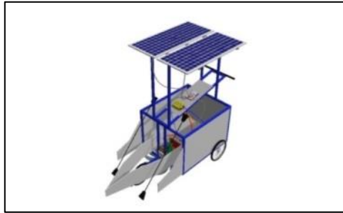
Gambar 2.4 Mesin Potong Padi Dua lajur
