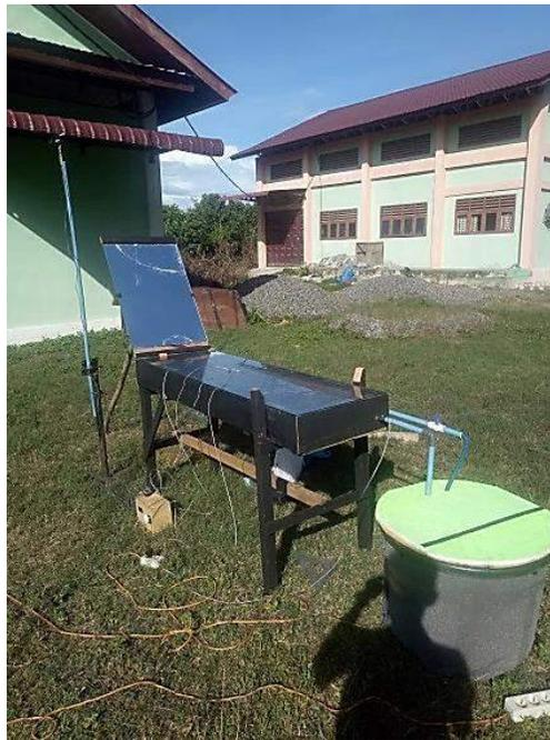
**Gambar 4.1** Pemanas Air Tenaga Surya menggunakan kaca reflector
